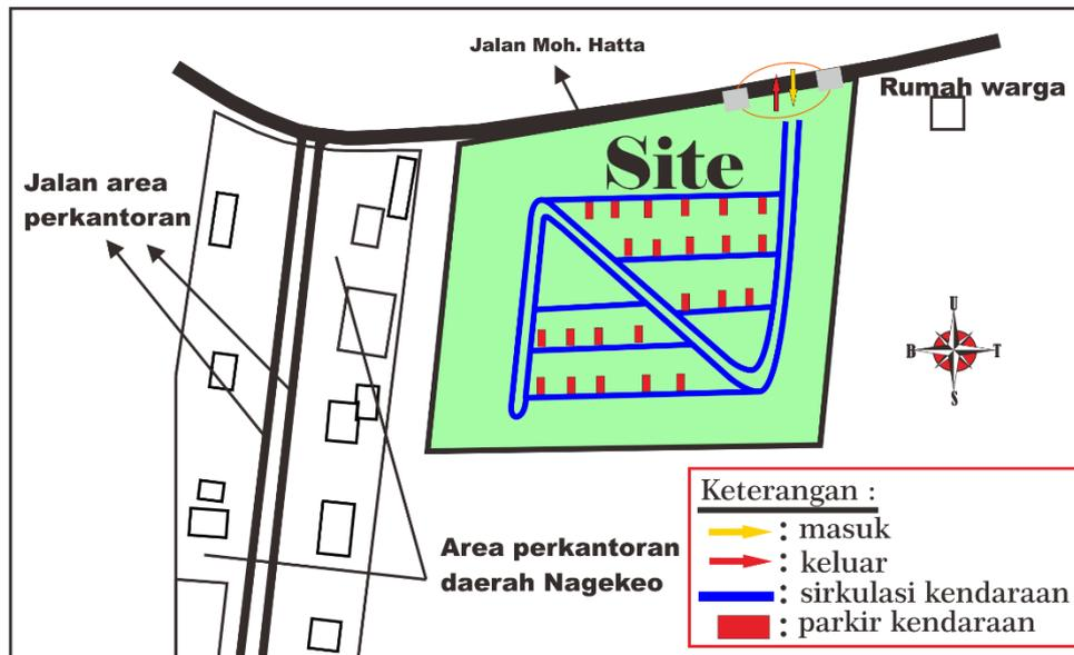
Gambar 5.21 : Analisa Penempatan Parkir Alternatif 2
