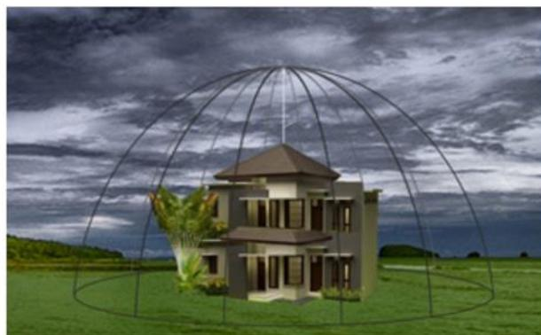
Gambar 5.58 : Skema penangkal petir temradius alternatif 1
