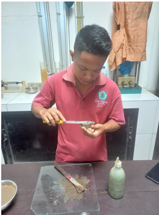
Pengujian Analisa Saringan dan Attreberg Limid
