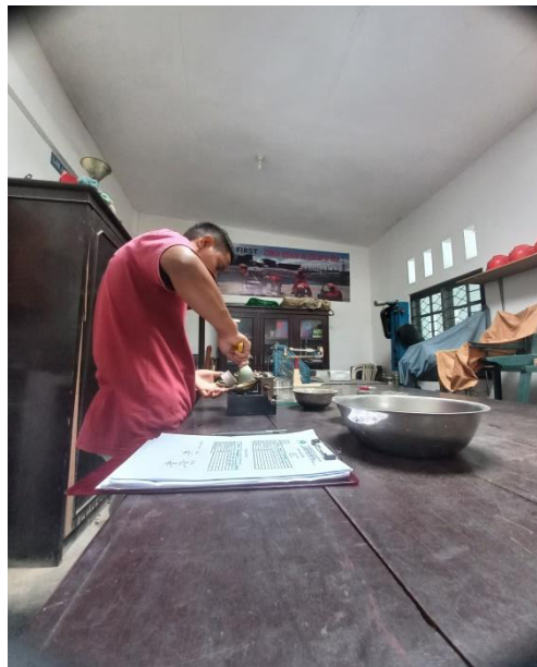
Pengujian campuran abu batu, abu terbang dan abu sekam padi
