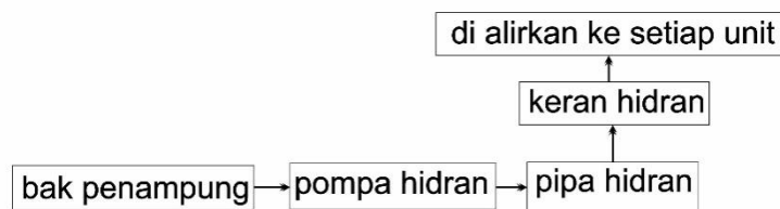
Gambar 5.49 Skema Sistem Pemadam Kebakaran (Sumber : Analisis Pribadi, 2023)
