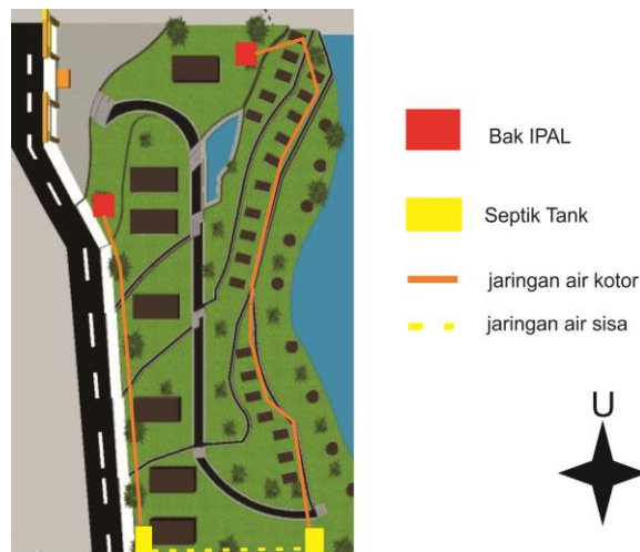
Gambar 6.26 Sistem Air Kotor (Sumber: Analisis Penulis, 2023)
