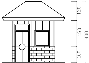
TAMPAK DEPAN POS JAGA SKALA 1:100
