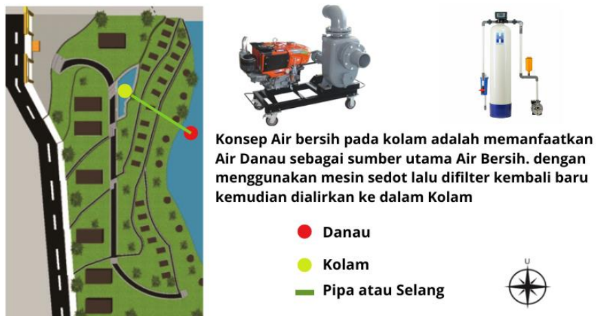
Gambar 6.25 Sistem Air Bersih pada Kolam (Sumber : Analisis Penulis, 2023)
