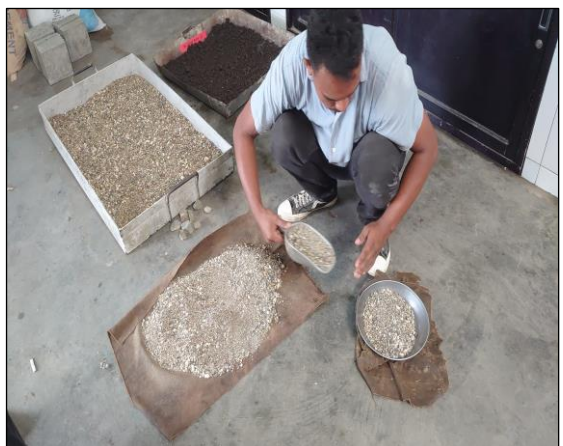
Persiapan Gradasi Agregat Halus Ex. Kali Lowolaka
