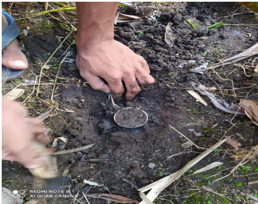
Gambar 2. Pengambilan sampel tanah menggunakan ring sampel
